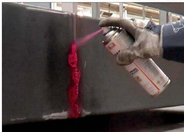
La estanqueidad de los cubetos de retención se comprueba mediante la denominada prueba rojo-blanco o líquidos penetrantes. Al hacerla, un líquido de prueba coloreado penetra a través de cada irregularidad del objeto testeado. Al aplicar una capa de revelador, se crea una contracapilaridad que hace visibles los huecos, grietas y otras imperfecciones.
